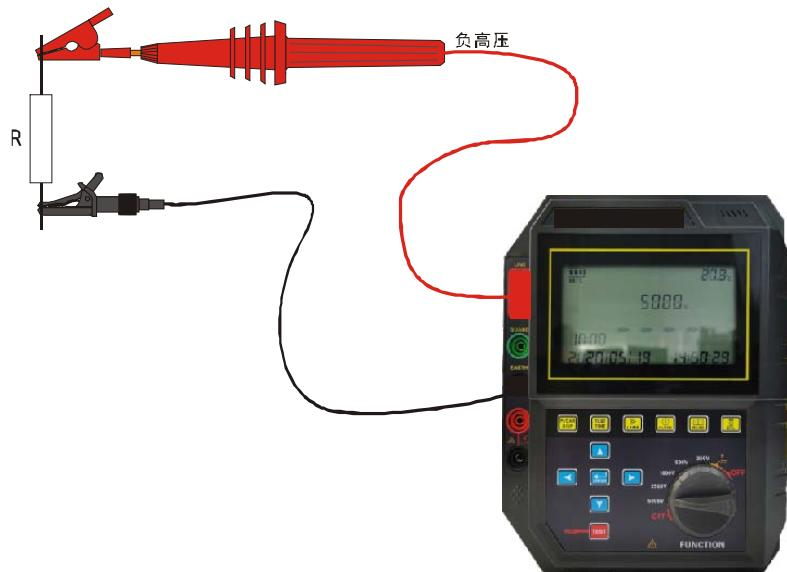
3、测量绝缘电阻时，红色高压棒夹子(LINE)接在被测设备上；黑色测试线夹子 (EARTH) 接在被测回路接地端，即被测设备的外壳或者大地。绿色测试线夹子 (GUARD) 接在被测试物的屏蔽部分或者其他不参与测量的部分，以消除表面泄漏电流的影响（详见“屏蔽端 GUARD 线的使用方法”相关内容。如下图所示：
